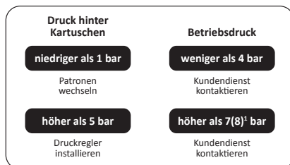
Abbildung 9. Betriebsparameter des Systems
